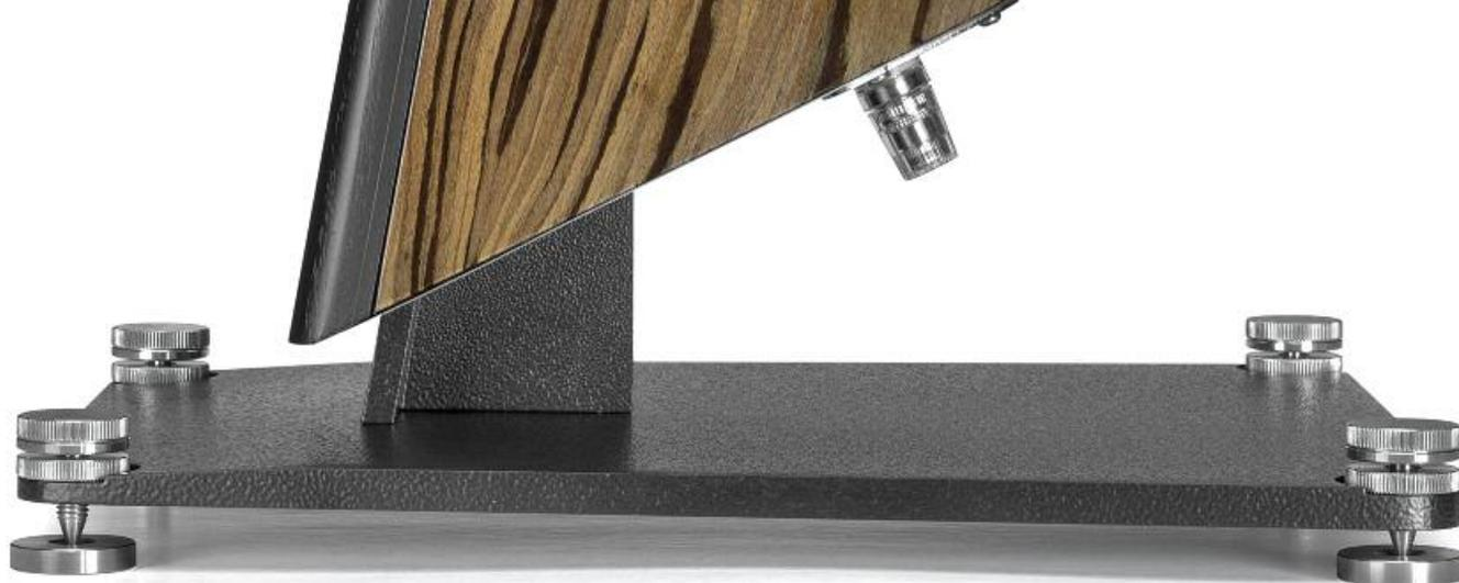
Auf festem Grund: Die massive Bodenplatte der Aptica Mk II ist aus lasergeschnittenem Eisen, die robusten Spikes und Unterlegscheiben sind aus Edelstahl gefertigt. Wegen des nach unten geneigten Terminals sollte darauf geachtet werden, dass starrere Lautsprecherkabel mit Bananensteckern genug Platz haben, ohne geknickt werden zu müssen
