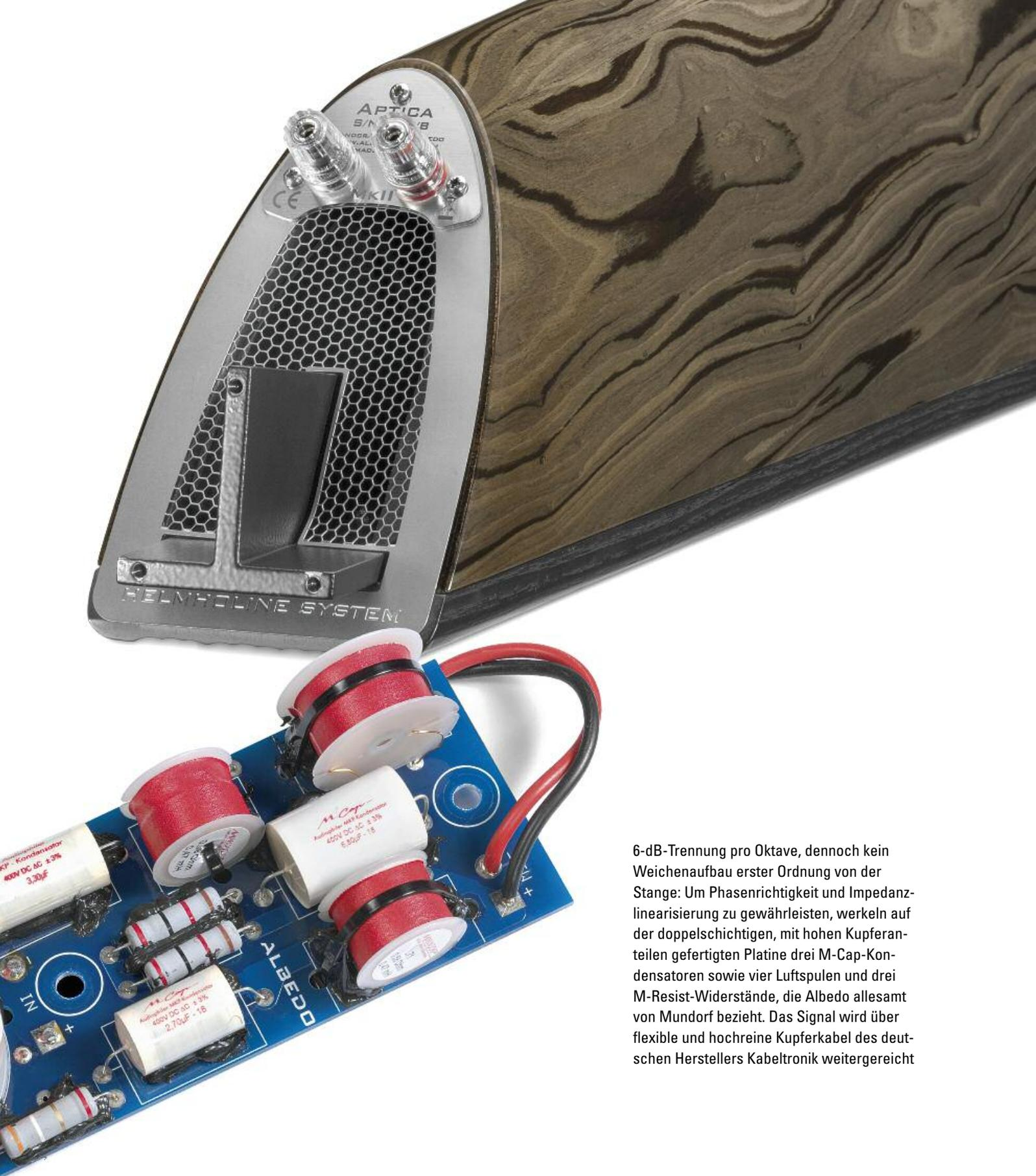
6-dB-Trennung pro Oktave, dennoch kein Weichenaufbau erster Ordnung von der Stange: Um Phasenrichtigkeit und Impedanzlinearisierung zu gewährleisten, werkeln auf der doppelschichtigen, mit hohen Kupferanteilen gefertigten Platine drei M-Cap-Kondensatoren sowie vier Luftspulen und drei M-Resist-Widerstände, die Albedo allesamt von Mundorf bezieht. Das Signal wird über flexible und hochreine Kupferkabel des deutschen Herstellers Kabeltronik weitergereicht
