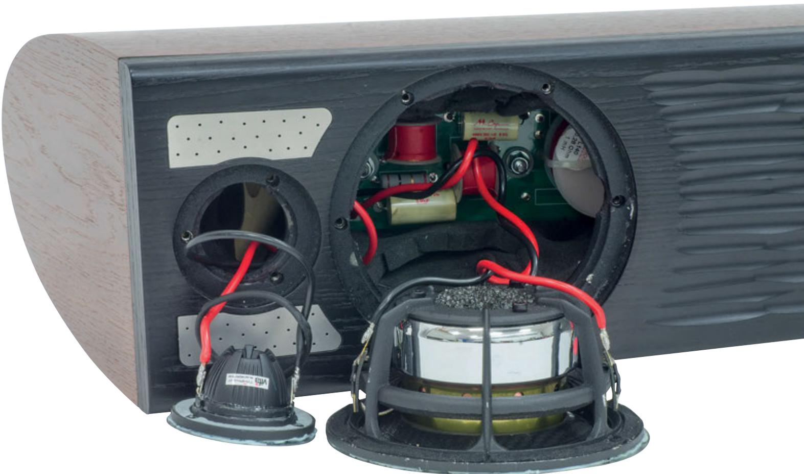
I due trasduttori rimossi dal pannello frontale. Notiamo la camera di decompressione del tweeter e l'originale cestello, acusticamente trasparente, del midwoofer. Il filtro crossover è posizionato in prossimità degli altoparlanti.
