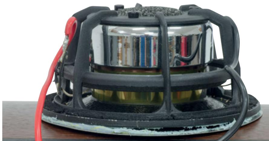
*Il midwoofer è realizzato su specifiche del costruttore italiano. Notiamo la larga bobina mobile, la tazza di copertura cromata e la resistenza acustica posta sul foro posteriore del complesso magnetico.*
