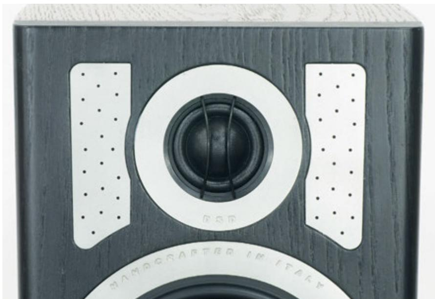
Il DSD (Diffraction Shaping Device) è costituito da due piccoli volumi coperti da una ghiera metallica forata. Si tratta di un dispositivo assimilabile ad un risonatore di Helmholtz che regolarizza la risposta del tweeter riducendo l'effetto distruttivo delle diffrazioni dei bordi.
