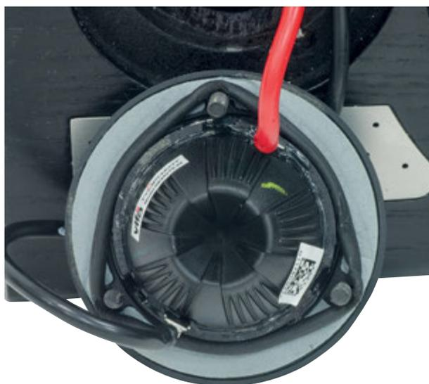
*La camera posteriore del tweeter è disegnata in modo da non creare al suo interno percorsi preferenziali, così da smorzare le colorazioni dell'emissione posteriore della cupola. Notare anche la guarnizione elastica tangente alle tre viti, che crea una sorta di disaccoppiamento tra la flangia e il mobile.*
